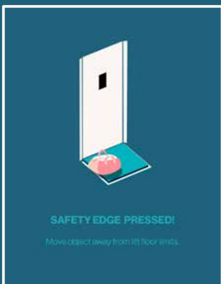
ระบบตรวจจับสิ่งกีดขวาง
